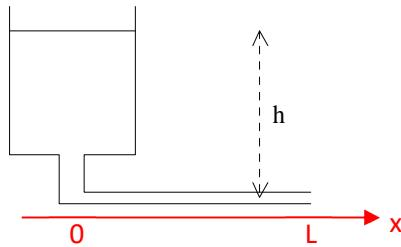
On admet que le débit dans le tube horizontal est donné par la loi de Poiseuille :  $q_v = \frac{\Delta P}{128\eta L} \pi d^4$
