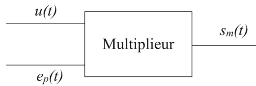
Figure 9 – Multiplication de l'onde porteuse et signal modulé
