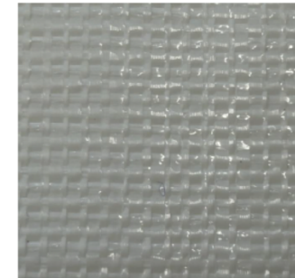
Toile en PP Utilisée actuellement pour les big-bags
