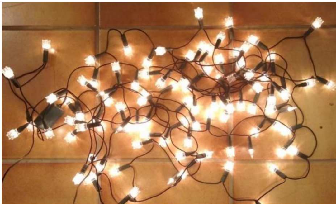
FIGURE 1 – guirlande électrique composée d'ampoules à incandescence.
