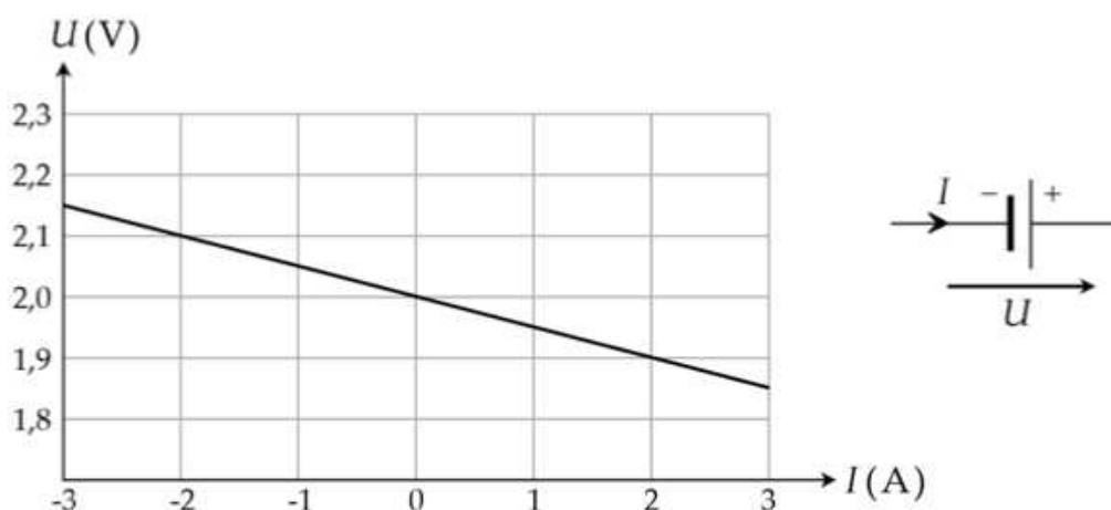
FIGURE 2 – Caractéristique statique d'un accumulateur chargé à 50 %
