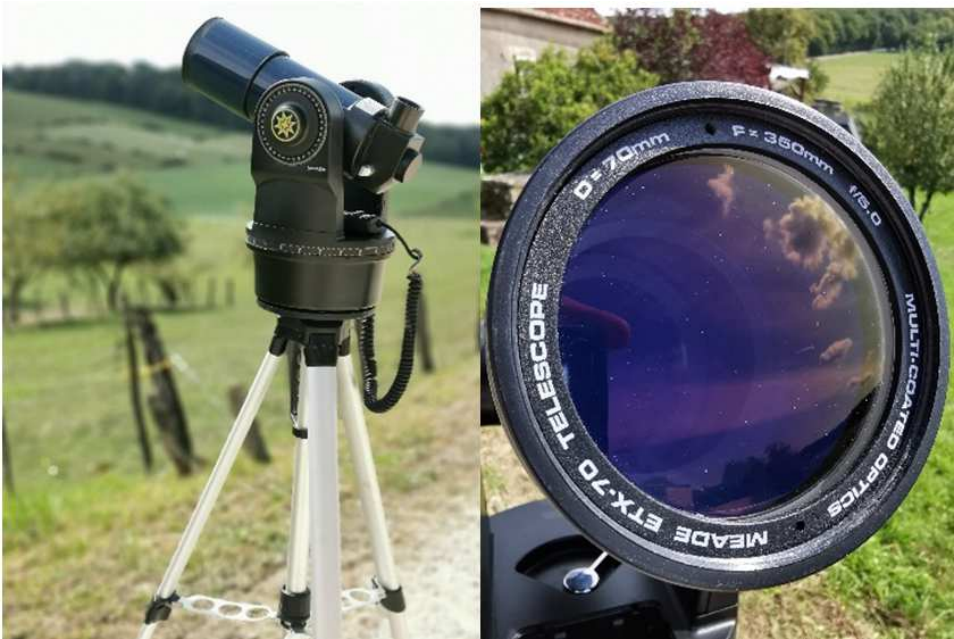
FIGURE 1 – : à gauche lunette ETX70, à droite objectif de l'ETX70.
