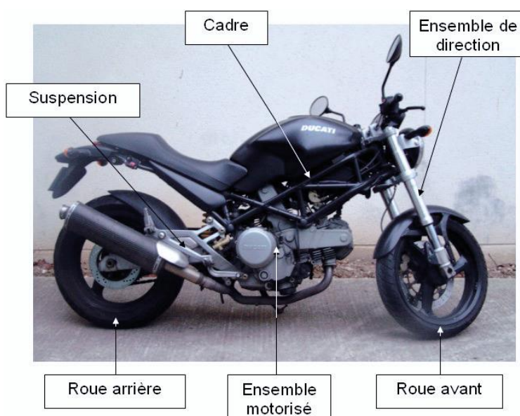
Figure 1 : Principaux composants d'une moto
