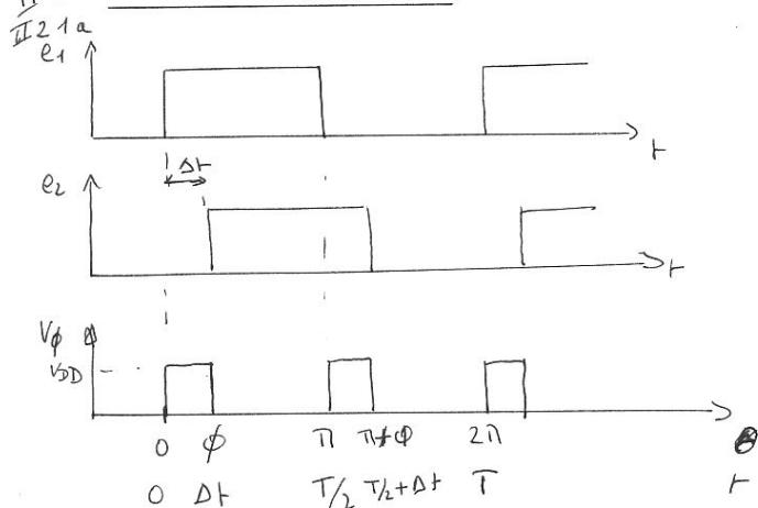
II 2 1b La fréquence du signal  $V_\phi$  est doublée  $\boxed{2F_o}$
