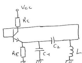
Le quadripôle de réaction est constitué de  $C_1$ ,  $C_2$  et  $L$
