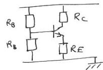
II 12a En négligeant le circuit de polarisation (résistances  $R_B$ ) et en remplaçant  $C_3$ , quartz et varicap par  $L$ , on obtient :
