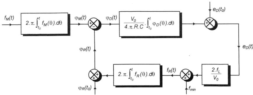
2.4 À  $t_0$ ,  $\varphi_R(t_0) = \varphi_M(t_0) = 0$  donc  $\varphi_D(t_0) = 0$  et pour avoir  $f_R = f_{R0}$  il faut  $e_D(t_0) = V_0/2$
