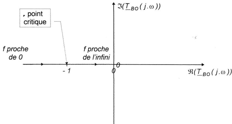
2.11 Lorsque le diagramme de Nyquist, relatif à la transmittance en boucle ouverte et parcouru dans le sens des fréquences croissantes, laisse le point critique (0 ; - 1) sur sa gauche, le système a un fonctionnement stable en boucle fermée.
